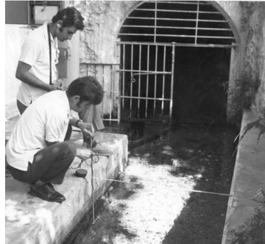
Μέτρηση ροής νερού (Φώτο: Αρχείο Τμήματος Αναπτύξεως Υδάτων)
