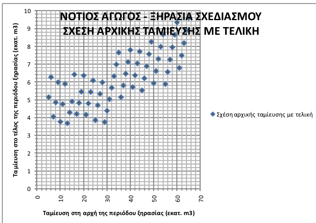
Σχήμα 6-3: Συσχέτιση όγκου ταμίευσης της αρχής με του τέλους της περιόδου ξηρασίας σχεδιασμού με βάση την προτεινόμενη πολιτική απολήψεων.
